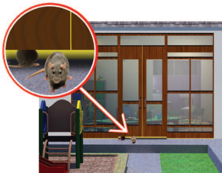
Instale burletes en las puertas.
